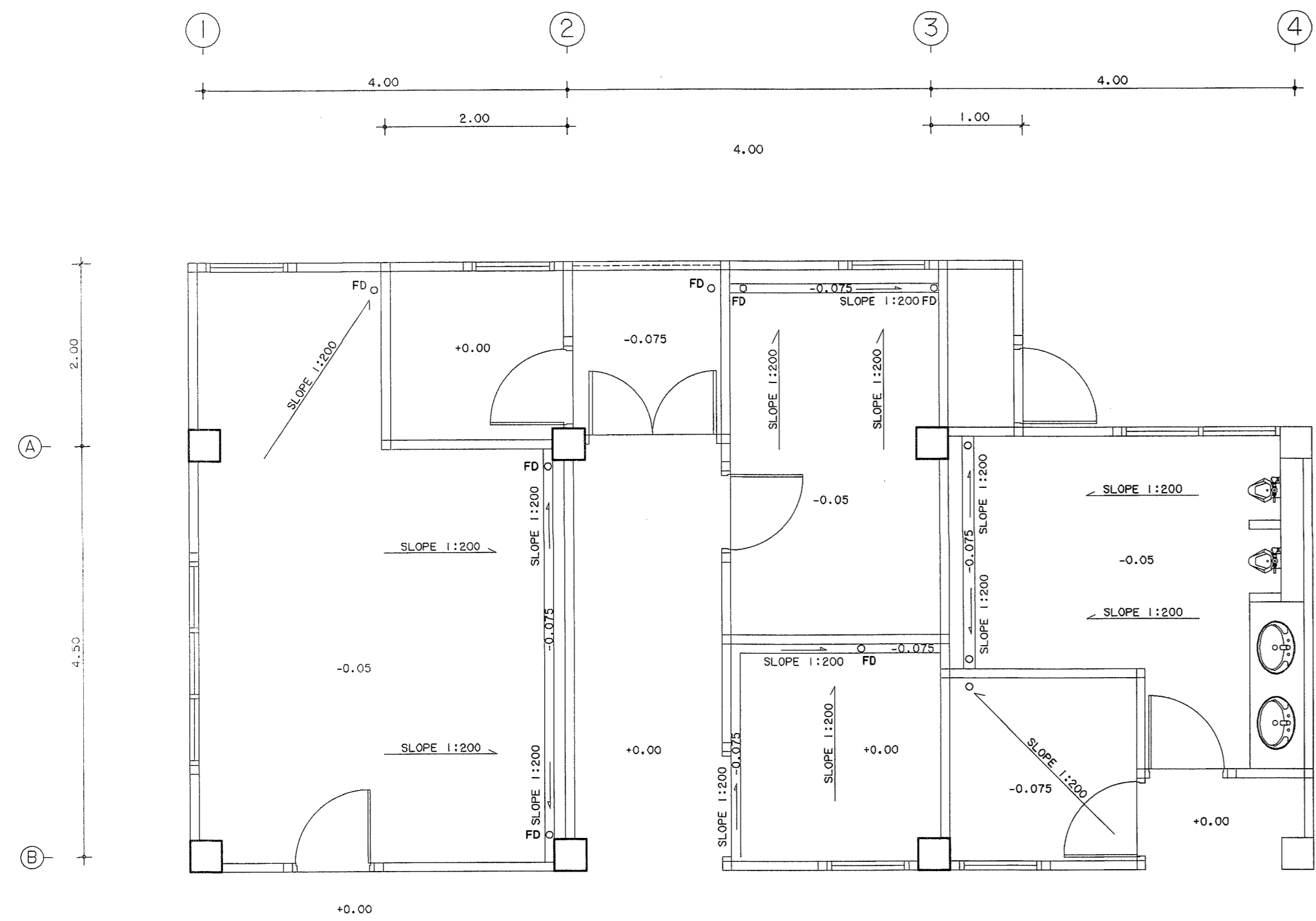
แบบขยายห้องน้ำ WC. 1-WC. 2 มาตราส่วน 1:50
